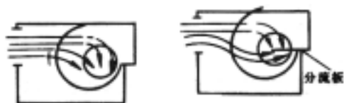
图 16 风机进口不对称气流产生的涡流及其改善方法
