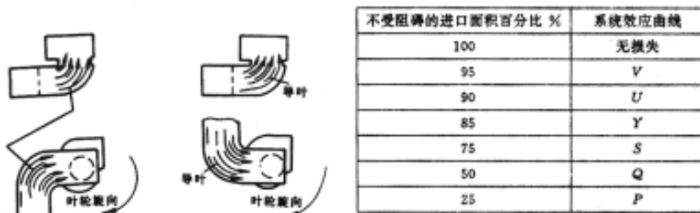
图 19 进口有障碍的系统效应曲线
